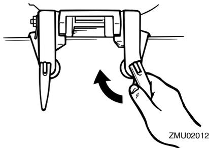
2. Si su motor está equipado con un gancho del cable de seguridad, debe utilizarse un cable o cadena de seguridad del motor. Fije un extremo al gancho del cable de seguridad del motor y el otro a un punto seguro de montaje en el barco.
