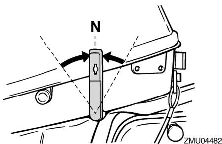
5. Si está instalado el tirador del estrangulador, sáquelo cuando el motor esté frío. Después de arrancar el motor, vuelva a poner gradualmente el tirador del estrangulador en su posición inicial al irse calentando el motor.
