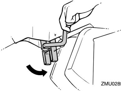
5. Sujete con una mano la parte posterior de la capota superior y levante totalmente el motor.
