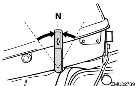
2. Eleve ligeramente el motor fueraborda. Lleve hacia arriba la palanca para navegar en aguas poco profundas.
