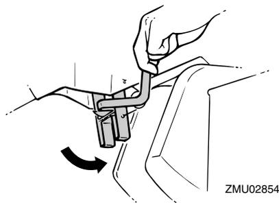
3. La palanca para navegar en aguas poco profundas se bloqueará, dando apoyo al motor fueraborda en una posición parcialmente elevada.
