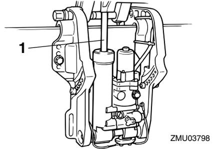
1. Empujador de trimado y elevación del cilindro elevador
