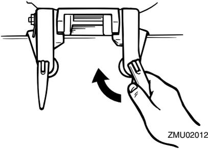
2. Si su motor está equipado con un gancho del cable de seguridad, debe utilizarse un cable o cadena de seguridad del motor. Fije un extremo al gancho del cable de seguridad del motor y el otro a un punto seguro de montaje en el barco. Si no se hace así, el motor podría perderse completamente si se desprendiese accidentalmente del peto de popa.
