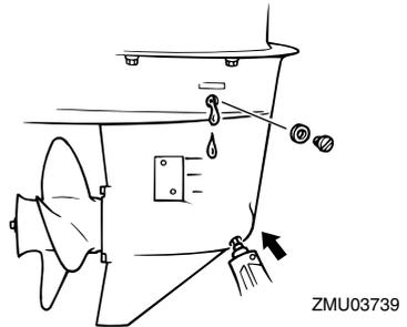
6. Coloque una nueva junta en el tapón del indicador del nivel de aceite. Cuando el aceite empiece a salir del orificio del tapón del indicador del nivel de aceite, inserte y apriete el tapón.
