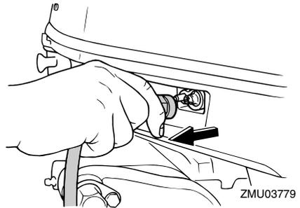
3. Apriete el suspiro de la tapa del tanque de combustible (si está instalada).
