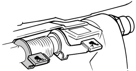
3. Para colocar el motor fueraborda en una posición parcialmente elevada, levante ligeramente el motor fueraborda hasta que gire completamente la placa.
