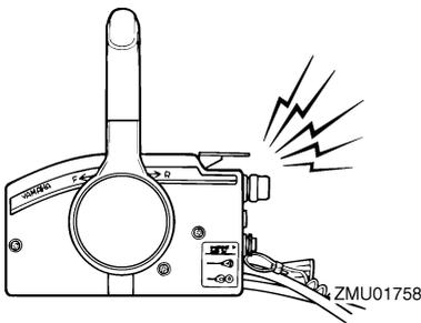
Si se hubiera activado el sistema de alarma, pare el motor y compruebe la entrada del agua de refrigeración para ver si está obstruida.
