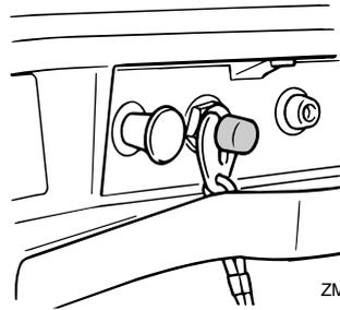
3. Sitúe el puño del acelerador en la posición "START" (arranque).
