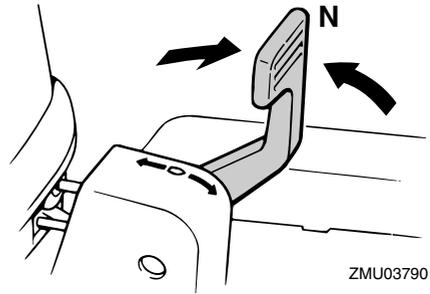
2. Baje la palanca para navegar en aguas poco profundas a la posición de liberación.
