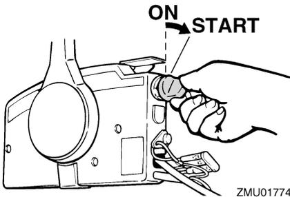
7. Inmediatamente después del arranque del motor, suelte el interruptor principal y deje que vuelva a la posición “ON” (activado).
