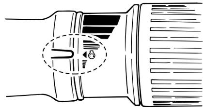
4. Extraiga/gire completamente el tirador del estrangulador. Después de arrancar el motor, sustituya/vuelva a colocar el tirador en la posición inicial.
