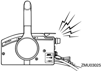
Si se hubiera activado el sistema de alarma, pare el motor y compruebe la causa.
