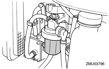
2. Desenrosque la taza del filtro, recogiendo con un trapo el combustible que se derrame.
