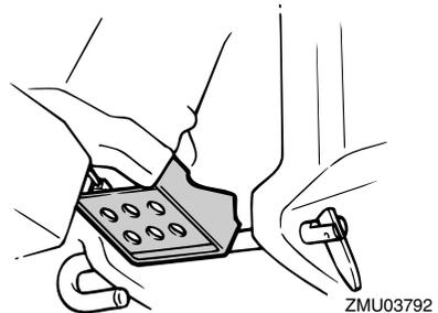
4. Para volver a colocar el motor fueraborda en la posición normal de marcha, ponga la palanca del control remoto/palanca de cambio de marcha en punto
