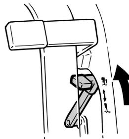
3. Sujete con una mano la parte posterior de la capota superior y eleve el motor hasta el ángulo deseado.
