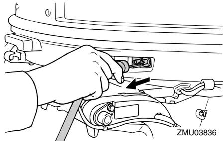
3. Ponga la palanca de bloqueo de la elevación en la posición de liberación.
