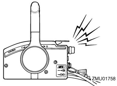
Si se hubiera activado el sistema de alarma, pare el motor y compruebe la causa.
