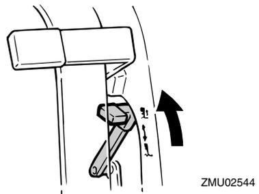
3. Eleve ligeramente el motor fueraborda hasta la posición deseada y baje la palanca de bloqueo de la elevación hasta
