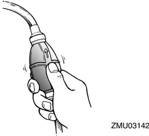
4. Abra ligeramente el acelerador sin cambiar de marcha utilizando el puño del acelerador o el acelerador en punto muerto. Es necesario cambiar ligeramente la abertura de aceleración en función de la temperatura del motor. Después de arrancar el motor, vuelva a poner el acelerador en su posición original.
