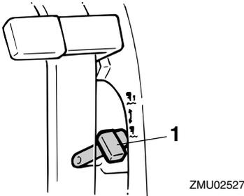
1. Palanca de bloqueo de la elevación
