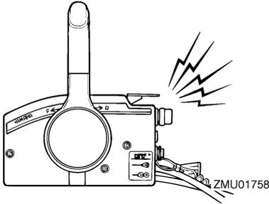
Si se hubiera activado el sistema de alarma, pare el motor y compruebe la entrada del agua de refrigeración para ver si está obstruida.
