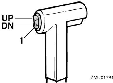
1. Interruptor de elevación y trimado del motor
