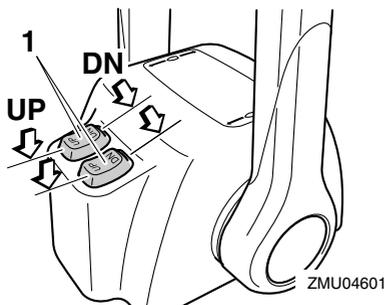
1. Interruptor de elevación y trimado del motor
