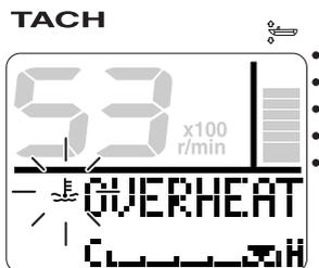
Si suena el zumbador y se activa el dispositivo de aviso de sobretemperatura, pare el motor de inmediato. Compruebe si la entrada del agua de refrigeración está obstruida.
