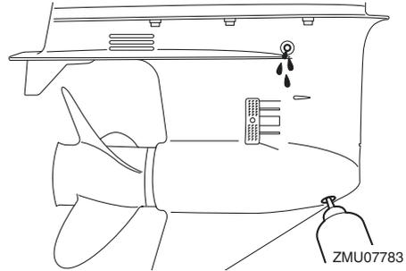
6. Coloque una junta nueva en el tapón del nivel de aceite. Cuando el aceite empiece a fluir del orificio del tapón del nivel de aceite, introduzca y apriete el tapón del nivel de aceite al par especificado.
