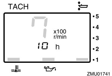
Para cambiar el formato del display, pulse el botón "mode" (modo). El display puede indicar las horas totales, las horas de singladura o desactivarse.
