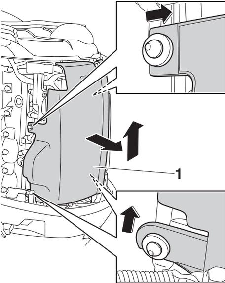
1. Tapa de la bobina de encendido
