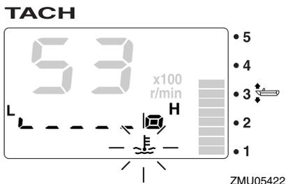
Pare el motor de inmediato si suena el zumbador y parpadea el indicador de aviso de presión de aceite baja. Compruebe la cantidad de aceite del motor y, si es necesario, añada más aceite. Si se activa el dispositivo de aviso y la cantidad de aceite del motor es correcta, póngase en contacto con su concesionario de Yamaha.
