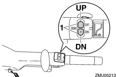
1. Interruptor de RPM para baja velocidad variable
