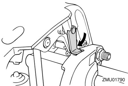
4. Modelos equipados con varillas de trimado: Una vez que el motor fueraborda esté apoyado en el soporte del motor elevado, pulse el interruptor de elevación y trimado del motor "DN" (hacia abajo) para replegar las varillas de trimado. **PRECAUCIÓN:** Asegúrese de retraer completamente las varillas de trimado durante el amarre. Esto protege las varillas contra la adherencia marina y la corrosión que podrían dañar el mecanismo de elevación y trimado del motor. [SCM00252]
