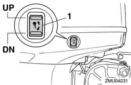
1. Interruptor de elevación y trimado del motor
