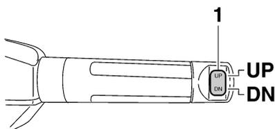
1. Interruptor de elevación y trimado del motor
