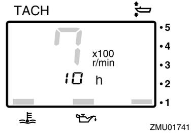
Para cambiar el formato del display, pulse el botón “mode” (modo). El display puede indicar las horas totales, las horas de singladura o desactivarse.
