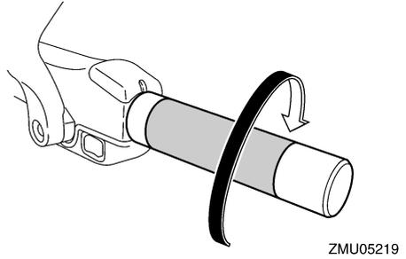
2. Una vez que el motor funcione a velocidad de ralentí con una marcha engranada, mueva la palanca de control remoto / palanca de cambio de marcha firmemente a la posición de punto muerto.
