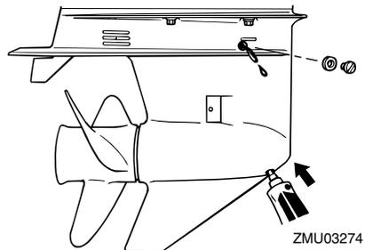
6. Coloque una junta nueva en el tapón del nivel de aceite. Cuando el aceite empiece a fluir del orificio del tapón del nivel de aceite, introduzca el tapón y apriételo.
