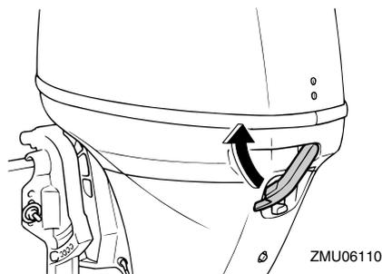
Después de la instalación, compruebe el ajuste de la capota superior empujando con ambas manos. Si está suelta, contacte con su concesionario Yamaha para solicitar una reparación.
