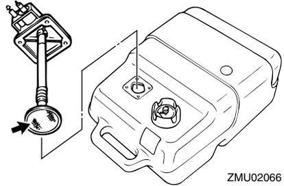
4. Limpie el filtro (situado en el extremo del tubo de aspiración) con un disolvente de limpieza apropiado. Deje secar el filtro.
