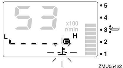
Pare el motor de inmediato si suena el zumbador y parpadea el indicador de aviso de presión de aceite baja. Compruebe la cantidad de aceite del motor y, si es necesario, añada más aceite. Si se activa el dispositivo de aviso y la cantidad de aceite del motor es correcta, póngase en contacto con su concesionario de Yamaha.
