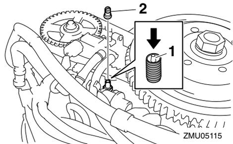
1. Varilla de conexión del estrangulador
