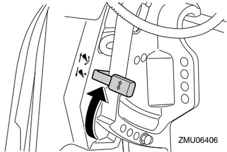
3. Sostenga la parte posterior de la capota superior con una mano e incline el motor hasta el ángulo deseado.
