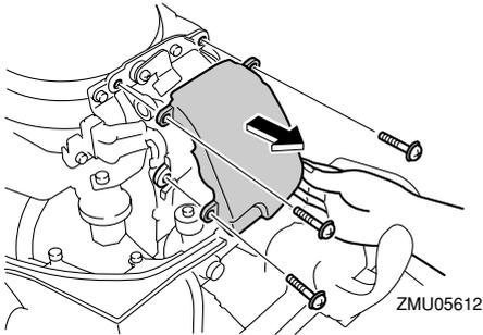
4. Retire el tornillo o los tornillos de la placa y bájela.
