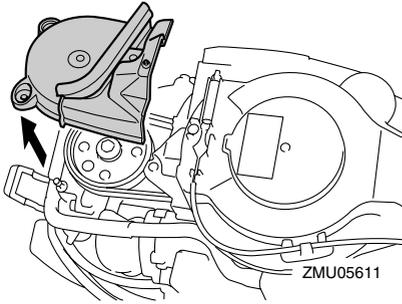
3. Extraiga la tapa del sistema eléctrico retirando los tornillos.
