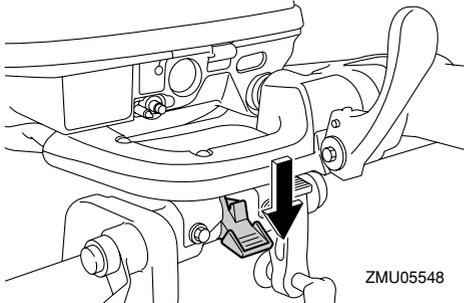
3. Lleve hacia arriba la palanca para navegar en aguas poco profundas (si está instalada).
