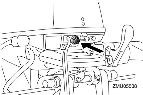
5. Inmediatamente después del arranque del motor, suelte el botón de arranque y deje que vuelva a su posición original.
