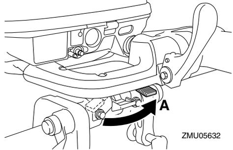
3. Sujete los puños y los soportes de la dirección según se muestra en la ilustración y levante el motor fueraborda con la ayuda de otra persona.
