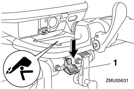
1. Palanca de bloqueo de la elevación (liberación/elevación)
