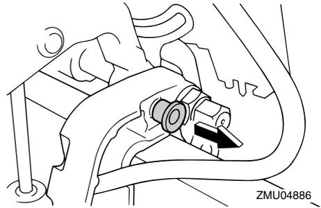
3. Pulse el interruptor de elevación del motor "DN" (hacia abajo) para bajar el motor fueraborda a la posición deseada.
