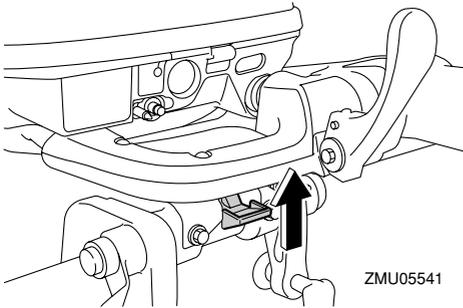
2. Eleve ligeramente el motor hasta que la barra soporte se libere automáticamente.
