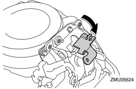
5. Quite la tapa del motor de arranque/volante retirando el perno o los pernos.
