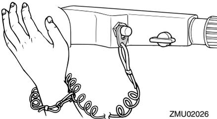
6. Introduzca el extremo anudado del cabo de arranque de emergencia en la muesca del rotor del volante y enrolle el cabo 1 o 2 vueltas alrededor del volante en
