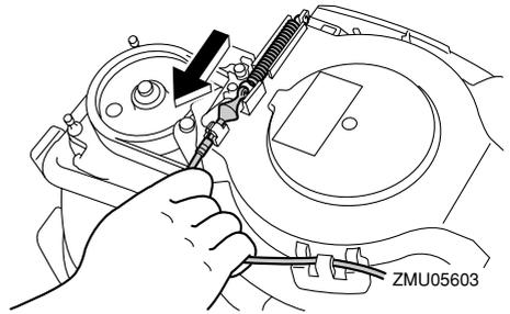
4. Quite la tapa del motor de arranque/volante retirando el perno o los pernos.
