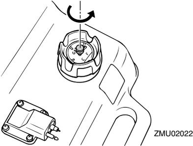
2. Si existe un conector de gasolina en el motor, conecte firmemente al mismo el tubo de combustible. A continuación, conecte el otro extremo del tubo de combustible al conector del tanque de combustible.
