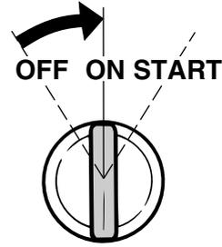
7. Prepare el motor para arrancarlo. Para más información, vea la página 32. Compruebe que la palanca de cambio de marcha se encuentra en punto muerto y que el seguro está fijado al interruptor de hombre al agua. El interruptor principal debe estar en la posición "ON" (activado), si está instalado.
