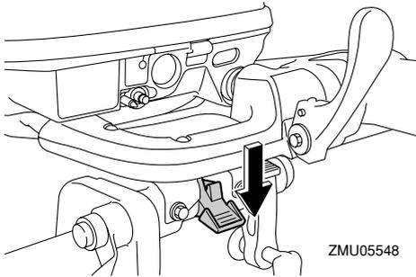
3. Eleve ligeramente el motor fueraborda. La barra soporte se bloqueará automáticamente, dando apoyo al motor fueraborda en una posición parcialmente elevada.
