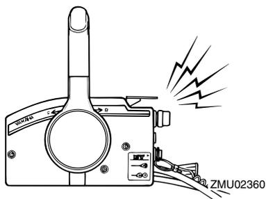
Si se hubiera activado el sistema de alarma, pare el motor tan pronto como sea seguro hacerlo así. Compruebe el nivel de aceite y añada aceite según sea necesario. Si el nivel de aceite es correcto y el dispositivo de alarma no se desconecta, consulte a su concesionario Yamaha.
