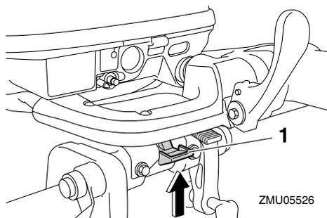
1. Palanca de bloqueo de la elevación (bloqueo/bajada)
