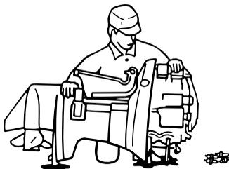
3. Drene el combustible del carburador, filtro de gasolina y tubo de combustible.
