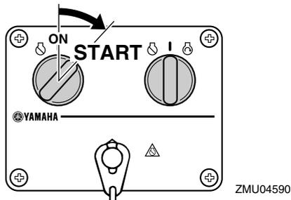
5. Inmediatamente después del arranque del motor, suelte el interruptor principal y deje que vuelva a "ON" (activado).
