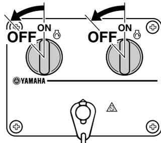
2. Después de parar el motor, desconecte el tubo de combustible o cierre la llave del combustible si hay un conector de gasolina o una llave del combustible en el barco.
