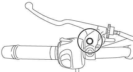
Cada vez que conduzca, debe antes verificar el funcionamiento de las manetas de freno y embrague y engrasar los pivotes de las manetas si es necesario.
