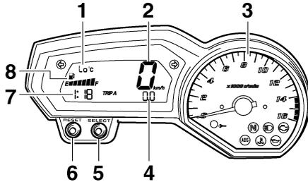
1. Indicación de temperatura del refrigerante/indicación de temperatura de admisión de aire
