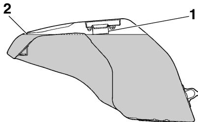
1. Tubo de llenado del depósito de gasolina
