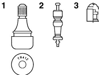
1. Válvula de aire del neumático
