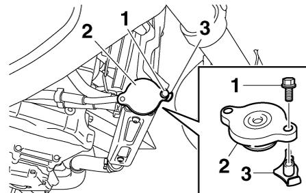
1. Perno de sujeción del tapón del radiador
