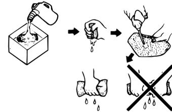
4. Die gesamte Oberfläche des Filterschaumstoffes mit dem vorgeschriebenen Öl benetzen und dann überschüssiges Öl ausdrücken.
