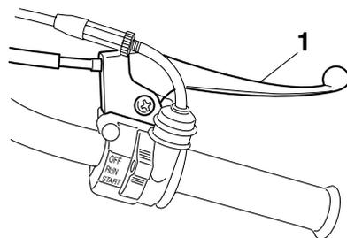
1. Handbremshebel (Vorderradbremse)
