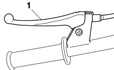
1. Handbremshebel (Hinterradbremse)
