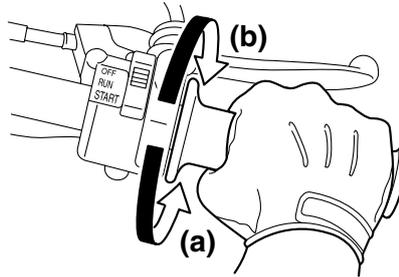
Die Fahrgeschwindigkeit wird durch Gasgeben und Gaswegnehmen angepasst. Zum Beschleunigen den Gasdrehgriff in Richtung (a) drehen. Zum Gaswegnehmen den Gasdrehgriff in Richtung (b) drehen.
