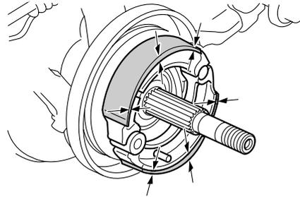
Misst die Stärke eines Trommelbremsbelags weniger als 1.5 mm (0.06 in), die Trommelbremsbeläge im Satz von einer Yamaha-Fachwerkstatt austauschen lassen.
