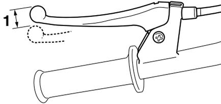
1. Spiel des Handbremshebels (Hinterradbremse)
