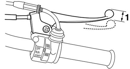
1. Spiel des Handbremshebels (Vorderradbremse)
