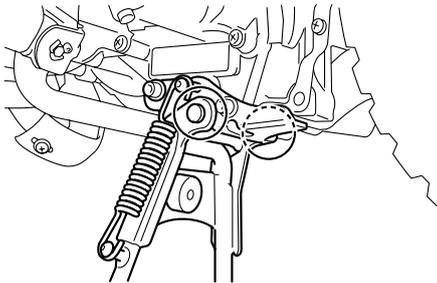
Vor jeder Fahrt und in den empfohlenen Abständen gemäß Wartungs- und Schmier-tabelle prüfen, ob sich der Hauptständer leicht ein- und ausklappen lässt und ggf. den Klappmechanismus schmieren.
