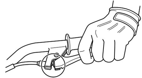
Die Hebel-drehpunkte der Vorderrad- und Hinterrad-Bremshebel sollten in den empfohlenen Abständen gemäß Wartungs- und Schmier-tabelle geschmiert werden.
