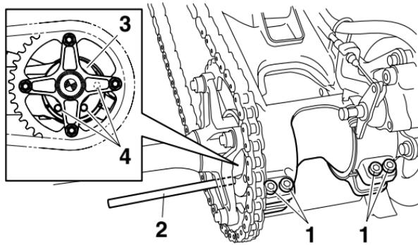
1. Remache de plástico desmontable del eje de la rueda trasera
