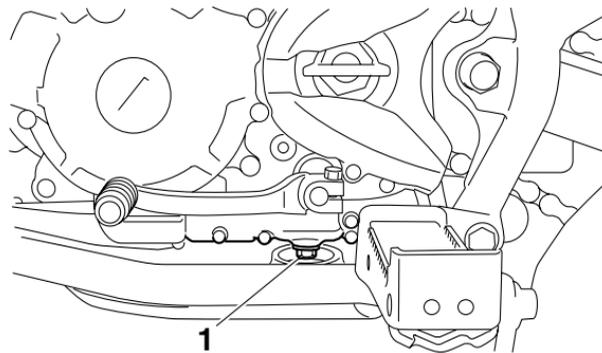
1. Perno de drenaje del aceite del motor
