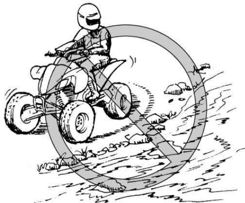
Compruebe los frenos cuando salga del agua. No siga conduciendo el ATV sin comprobar que éste ha recuperado su capacidad de frenado.
