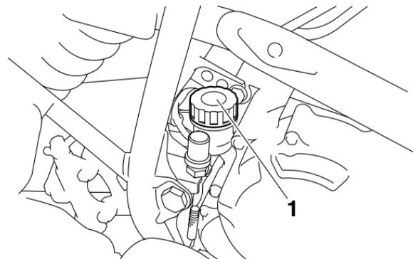
1. Tapa del depósito del líquido de freno
