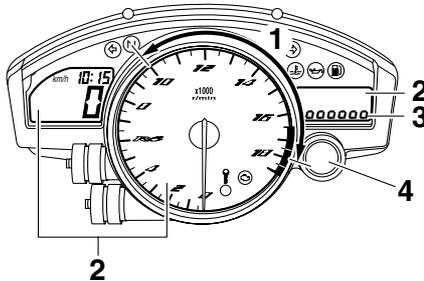
1. Margen de activación de la luz indicadora de la sincronización del cambio
