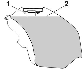
1. Tubo de llenado del depósito de gasolina
