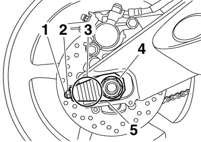
1. Perno de ajuste del juego de la cadena de transmisión
