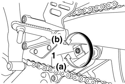
1. Tornillo de ajuste del hidráulico de extensión
