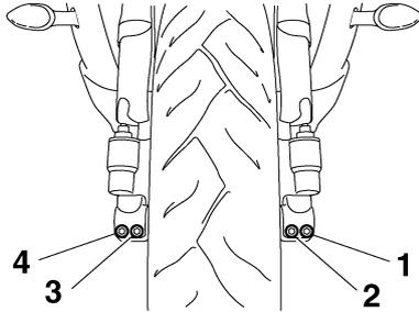
1. Remache de plástico desmontable del eje de la rueda delantera A
