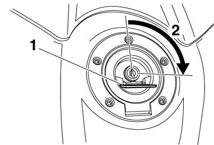
1. Cubierta de la cerradura del tapón del depósito de gasolina
