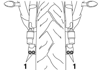
1. Remache de plástico desmontable del eje de la rueda delantera
