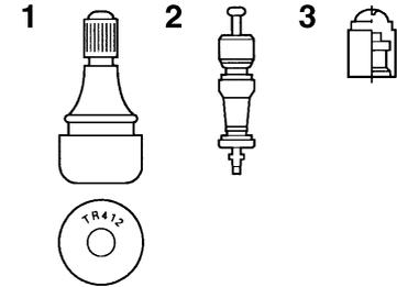
1. Válvula de aire del neumático
