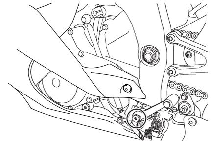
Cada vez que conduzca, compruebe antes el funcionamiento de los pedales de freno y cambio y engrase los pivotes de los pedales si es necesario.
