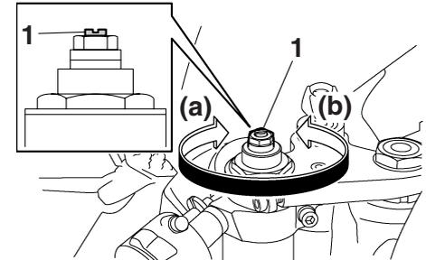
1. Tornillo de ajuste del hidráulico de extensión
