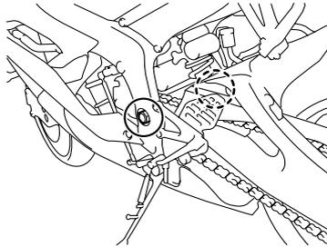
Los pivotes del basculante se deben engrasar en un concesionario Yamaha según los intervalos que se especifican en el cuadro de mantenimiento periódico y engrase.
