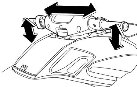
Gírelo todo lo que pueda hacia la izquierda y hacia la derecha para verificar que la tobera de propulsión se mueve a medida que gira el manillar, y que no hay diferencia entre las po-
