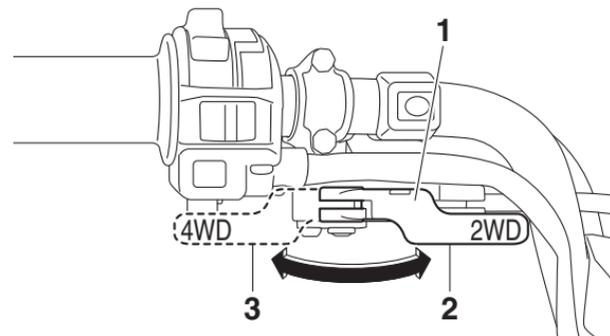
1. Palanca de tracción “2WD / 4WD”
