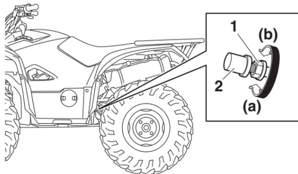
1. Tuerca de ajuste del interruptor de la luz del freno trasero
