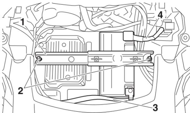
1. Placa de sujeción de la batería
