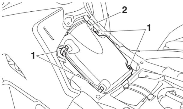
1. Soporte de la cubierta de la caja del filtro de aire
