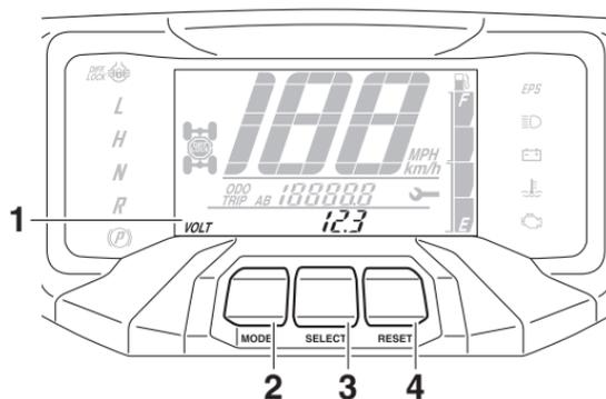
1. Reloj/Cuentahoras/Indicación del voltaje/Visor de la temperatura del refrigerante
