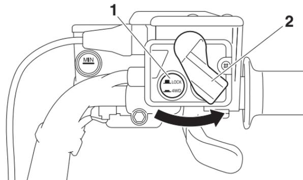
1. Selector de tracción On-Command “4WD/LOCK”
