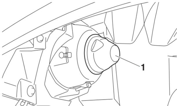
1. Cubierta de la parte posterior del faro
