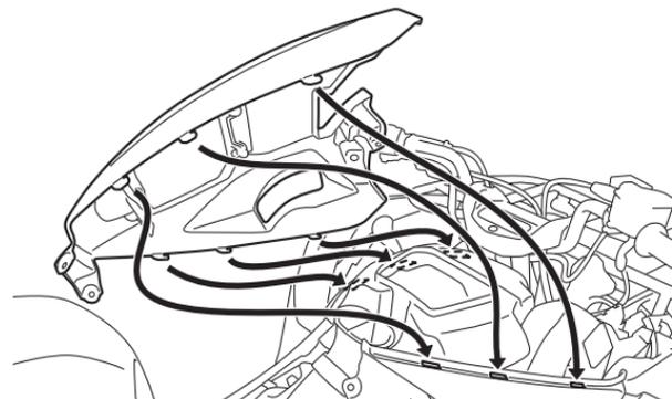
2. Coloque los tornillos, las fijaciones rápidas, los pernos y los tubos.
