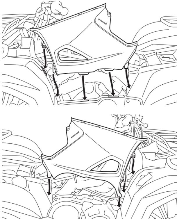
2. Instale los paneles A y C.
