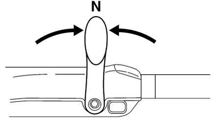
2. Coloque la palanca de bloqueo de la elevación en la posición desenganchada.
