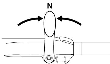
2. Lleve hacia arriba la palanca de bloqueo de la elevación hasta la posición de liberación.
