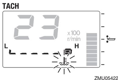
Pare el motor de inmediato si suena el zumbador y parpadea el indicador de presión de aceite baja. Compruebe la cantidad de aceite del motor y, si es necesario, añada más aceite. Si se activa el dispositivo de aviso y la cantidad de aceite del motor es correcta, póngase en contacto con su concesionario de Yamaha.
