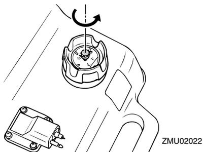
2. Si existe un conector de gasolina en el motor, alinee el conector de gasolina en la línea de combustible con el conector de gasolina en el motor y conecte firmemente la línea de combustible al conector mientras aprieta el conector. A continuación, conecte firmemente el otro extremo de la línea de combustible al conector en el depósito de combustible.
