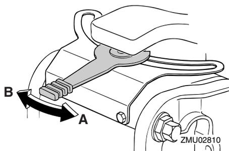
Si la resistencia no aumenta al girar la palanca al lado de babor "A", asegúrese de que la tuerca está apretada al par especificado.
