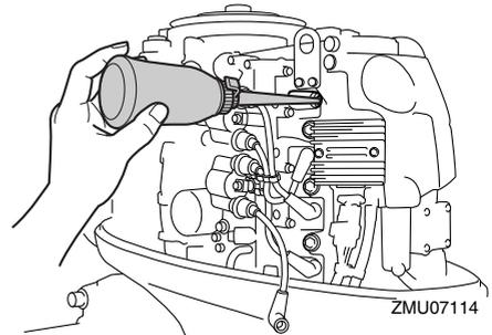
7. Drene la gasolina que quede en el separador de vapor con un recipiente. Afloje el tornillo de drenaje y retire el tapón. Presione la válvula de aire con un destornillador para introducir aire en la cámara del flotador, de tal forma que la gasolina se drene lentamente. A continuación, apriete el tornillo de drenaje.
