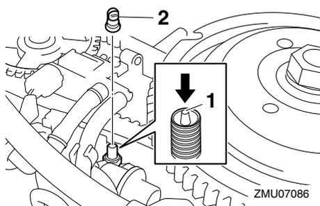
1. Varilla de conexión del estrangulador
