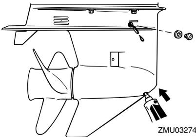
6. Coloque una junta nueva en el tapón del nivel de aceite. Cuando el aceite empiece a fluir del orificio del tapón del nivel de aceite, introduzca el tapón y apriételo.
