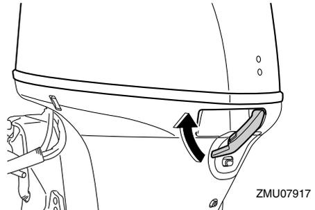
Después de la instalación, compruebe el ajuste de la capota superior empujando con ambas manos. Si está suelta, contacte con su concesionario Yamaha para solicitar una reparación.
