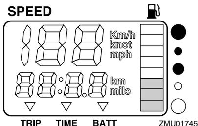
La lectura del nivel de combustible puede ser incorrecta debido a la posición del sensor en el tanque de combustible y por el asiento del barco en el agua. La navegación con el barco apogado o girando continuamente puede dar falsas lecturas.
