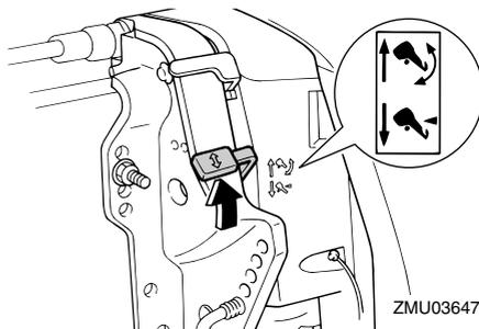
3. Eleve ligeramente el motor fueraborda hasta la posición deseada y baje la palanca de bloqueo de la elevación hasta la posición de bloqueo.
