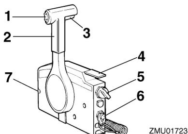
1. Interruptor de elevación y trimado del motor
