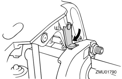
4. Una vez que el motor fueraborda esté apoyado en el soporte del motor elevado, pulse el interruptor de elevación y trimado del motor "DN" (hacia abajo) para replegar las varillas de trimado. **PRECAUCIÓN:** Asegúrese de retraer completamente las varillas de trimado durante el amarre. Esto protege las
