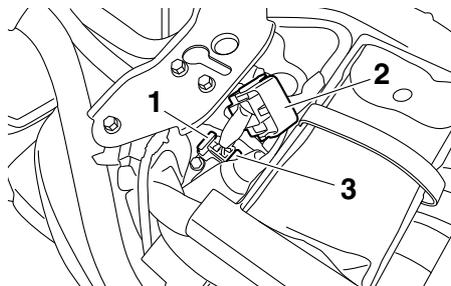
1. Fusible de rechange du système d'injection de carburant
