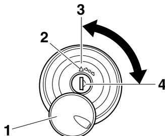
1. Cache-serrure du bouchon de réservoir de carburant
