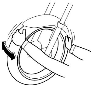
6 Contrôler les roulements de roue avant et arrière aux fréquences spécifiées dans le tableau des entretiens et graissages périodiques. Si le moyeu de roue a du jeu ou si la roue ne tourne pas régulièrement, faire contrôler les roulements de roue par un concessionnaire Yamaha.
