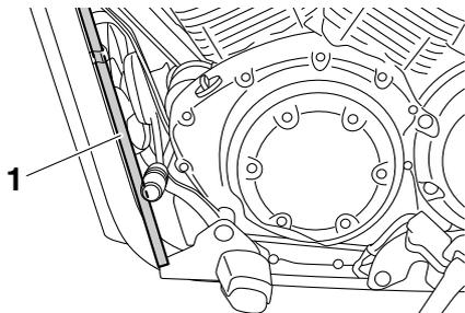
1. Durite de mise à l'air/de trop-plein du réservoir de carburant
