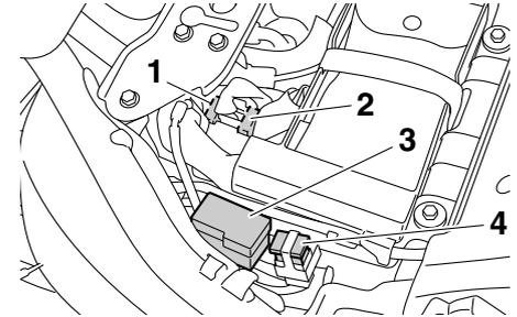
1. Fusible de rechange du système d'injection de carburant
