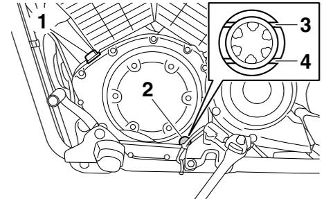
1. Bouchon de remplissage de l'huile moteur
