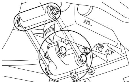
Faire lubrifier les articulations de la suspension arrière par un concessionnaire Yamaha aux fréquences spécifiées dans le tableau des entretiens et graissages périodiques.
