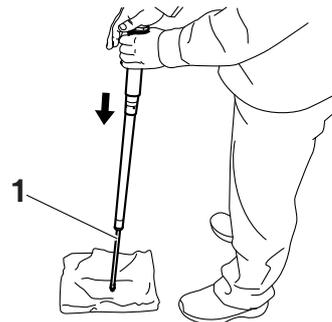
12. Das überschüssige Öl aus der Bohrung "a" im Dämpferrohr auslaufen lassen.
