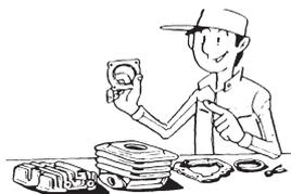
4. Durante il disassemblaggio del mezzo, pulire tutti i componenti e posarli su bacinelle nell'ordine di disassemblaggio. Ciò consente un assemblaggio più veloce e favorisce la reinstallazione corretta di tutti i componenti.
